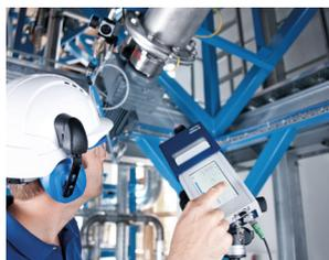
ausgestattete Messsystem ist sowohl robust genug für Feldstudien als auch empfindlich genug, um auftretende Signalanomalien zu erkennen, z. B. wenn es zur Zustandsüberwachung von Maschinen und Anlagen eingesetzt
