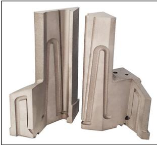
Werkzeug- und Formenbau anzubieten. Im SLM-Verfahren werden die Bauteile durch das schichtweise Aufschmelzen von metallischem Pulver generiert. Diese Fertigungstechnologie ermöglicht es, konturnahe Werkzeugtemperierungen umzusetzen und optimiert dadurch die Bauteilqualität und Zykluszeit in der Spritzgusspro-
