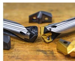
Die Geometrie der ISO-Klasse K wurde für Guss- und Sphärogussanwendungen entwickelt. Die Geometrie der ISO-Klasse N zeichnet sich durch ihre Eignung in weicheren Materialien wie Aluminium, Messing und Kupfer aus.
