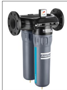
wasserstoffe, Öldämpfe und Gerüche aus der Druckluft. Die Aktivkohleschichten senken den Restölgehalt per Adsorption auf unter 0,003 mg/m<sup>3</sup>. Mit Wartungsintervallen von 8 000 oder 12 000 Stunden und Durchflussraten zwischen 1 500 und 6 500 Normkubikmetern pro Stunde findet sich in der QDT-Baureihe jetzt für alle Kompressoren mit Leistungen bis zu 750 kW eine passende Lösung. Weiterhin sind bei Atlas Copco nun die beiden Vorfilter UD+ 850T und
