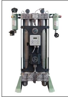
speziell für Hochdruckanwendungen. Die Hochdruck-Kältetrockner der Serie Sauer SRD eignen sich für die Trocknung von Luft und Gasen mit Enddrücken bis zu 420 bar(ü) und erzielen Drucktaupunkt von 3 bis 5 °C. Sie sind ebenfalls als Gaskühler einsetzbar. Die Hochdruck-Adsorptionstrockner der Serie Sauer SDD hingegen erzielen zuverlässige Drucktaupunkte von bis zu -40 °C bei Enddrücken bis 350 bar(ü). Sie sind speziell für die Verwendung mit Sauer Hochdruckkompressoren ausgelegt und optimiert.
