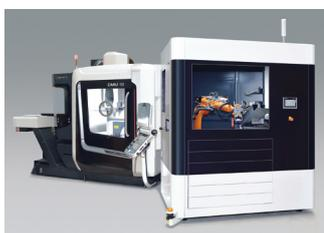
Produktbaukasten für das Werkstück-Handling für die Automatisierung von Dreh- und Fräsmaschinen entwickelt. Das System liefert genügend Flexibilität, um alle Kundenanforderungen wie unterschiedlichen Maße und Gewichte der Werkstücke einbringen zu können oder Zusatzprozesse wie Reinigen oder Entgraten zu integrieren.
