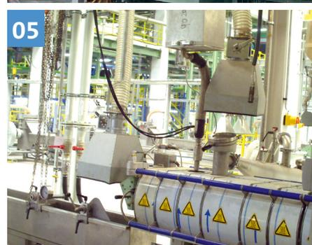
02 Absaugung Extruder mit Elektrofilter aus Edelstahl (8000 m³/h)
