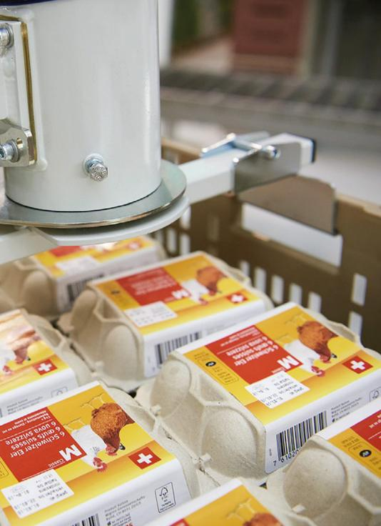
◀ Kleinladungsträger werden an nur zwei Punkten vom Greifer aufgenommen, was ein beschädigungsfreies Transportieren der Kisten ermöglicht
