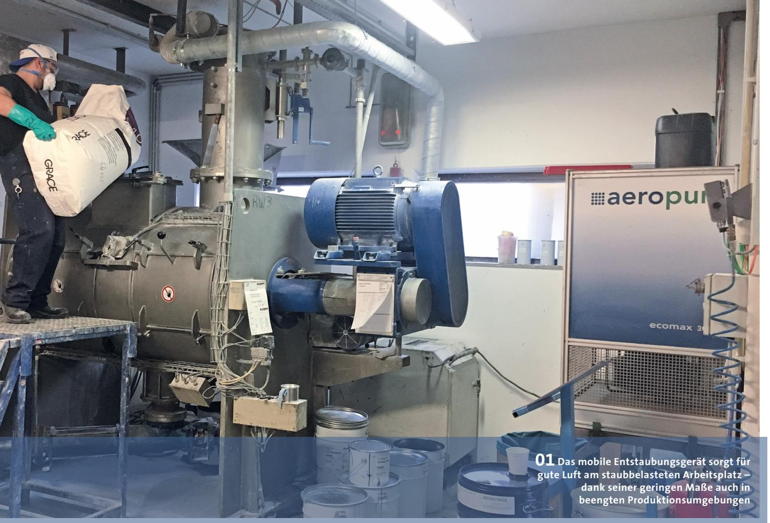
**01** Das mobile Entstaubungsgerät sorgt für gute Luft am staubbelasteten Arbeitsplatz – dank seiner geringen Maße auch in beengten Produktionsumgebungen
