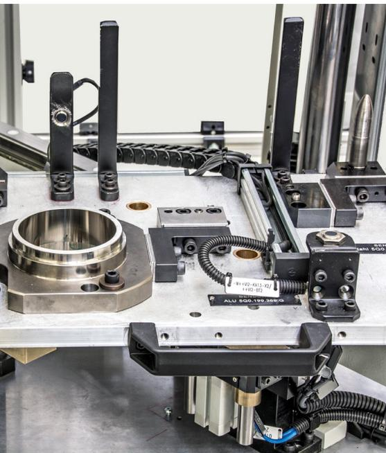
**01** Verschiebbarer Aufnahmetisch für das Druckgussteil zum positionsgenauen Beschicken der Rundlager-Eindrückstation
