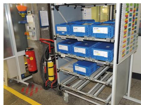
**02 Anwendungsbeispiel: Mobiles E-Kanban-System mit Funkschaltern in der Skiproduktion von Atomic**
