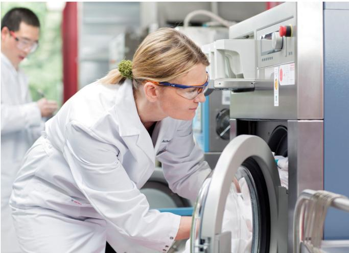
**02** Bevor Mewa ein Gewebe für die Produktion einer eigenen Kollektion zulässt, wird die Eignung im hauseigenen Technikum überprüft
