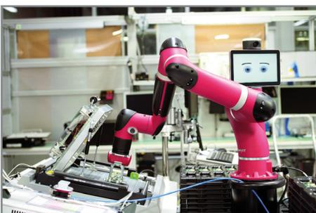
Rethink Robotics hat seinen smarten Cobot Sawyer mit neuen Funktionalitäten ausgestattet. Das Software-Update Intera 5.2 bietet nun Features wie die Echtzeit-Visualisierung von Produktionsdaten auf dem On-Board-Display des kollaborierenden Roboters, die einfache Integration externer Kameras und den schnellen Wechsel von Endeffektoren mit der ClickSmart-Technologie. Eingesetzt wird der Cobot z. B. in der Automobil- und
