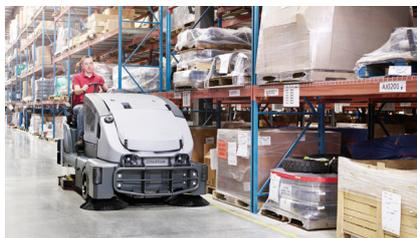
Reinigungsmitteldosiersystem „Ecoflex“ verfügt die Maschine nun über die patentierte „SmartFlow“-Technologie, mit deren Hilfe sich die Reinigungsproduktivität stark erhöht. Gleichgeblieben sind die Leistungsdaten des Kraftpakets, das in einem Durchgang kehren und scheuern kann: Ausgestattet mit 284 l fassenden Schmutz- und Frischwassertanks sowie einem 113 l großen Kehrgutbehälter
