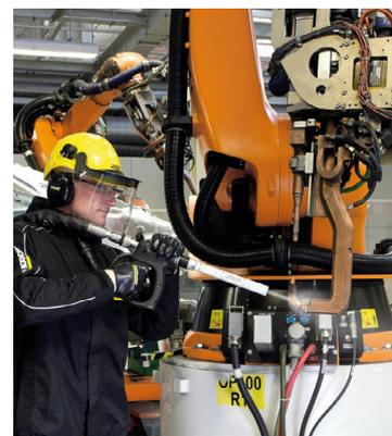
**T**rockeneisstrahlen wird immer dann eingesetzt, wenn herkömmliche Reinigungsmethoden keinen Erfolg bringen bzw. wenn es zu einem enormen zusätzlichen Aufwand führen würde, auf herkömmliche Weise zu reinigen oder wenn beispielsweise durch gesetzliche Vorschriften das Reinigen mit Wasser, Chemikalien, Lösemitteln oder anderen Partikelstrahlverfahren nicht zulässig ist.
