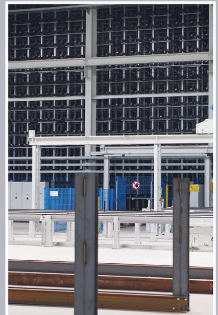
**02** Über 10.000 Kassetten fasst das neu installierte Unicomact-Wabenlager von Kasto
