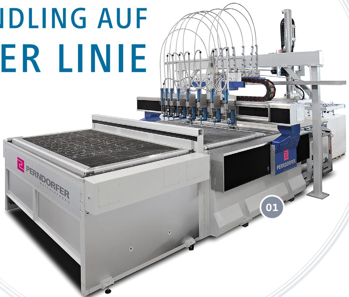
Linearachsen sind die Basis für die Konstruktion von Linearportalen bzw. kartesischen Robotern für die Be- und Entladung von Maschinen. Sie ermöglichen anwendungsoptimierte Lösungen, zum Beispiel in einer Wasserstrahl-Schneidanlage oder in Spritzgussmaschinen.
