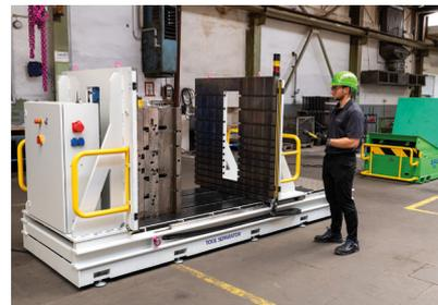
Sicheres und schnelles Handling tonnenschwerer Spritz-, Stanz- und Umformwerkzeuge ermöglicht der neue Tool Separator von Rud. Statt drei Stunden und drei Mitarbeiter braucht der Tool
