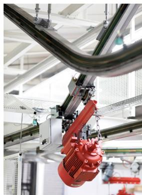
Bei der innovativen Elektrohängebahn (EHB) Skyrail wartet der Hersteller SEH Engineering bereits nach kurzer Zeit mit einem interessanten Update auf. Aufgrund einer Überarbeitung der Antriebseinheit ist diese noch einmal wesentlich verstärkt worden. „Statt der anfänglichen 400 kg im Zweifach- und 800 kg im Vierfachfahrzeug fährt Skyrail nun Lasten von 500 kg bzw. 1000 kg“, erklärt Holger Schmidt,
