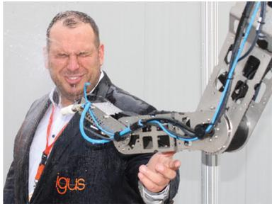
macht sich die Vorteile von zwei Materialien zunutze: Edelstahl und Hochleistungskunststoffe. Dabei bestehen die Verbindungselemente, erstmalig bei einem igus Roboter, aus rostfreiem V2- oder V4-Edelstahl und die Gelenke aus den
