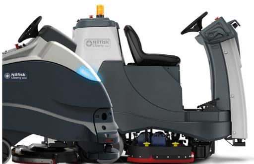
Reinigungseffizienz in großen Innenräumen wie Lagerhäusern, Leichtindustrienumgebungen u.ä. Die SC60 ergänzt die Fähigkeiten der weiteren autonomen Scheuersaugmaschine im Nilfisk-Portfolio, der Nilfisk Liberty SC50, die mit einem kleineren Formfaktor für die Reinigung in engeren Umgebungen entwickelt wurde, die mehr Präzision und Wendigkeit erfordern.
