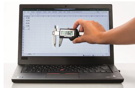
Die neuen Hoffmann Group Connected Tools verbinden analoge und digitale Werkzeugwelten ohne Zusatzsoftware oder Dongle. Die Werkzeuge senden Messdaten per Bluetooth über eine Distanz von bis zu 15 Metern und machen dadurch die Dokumentation besonders komfortabel. Gleichzeitig verbessern sie das Qualitätsmanagement, weil keine Fehler durch manuelle Datenübertragung entstehen.
