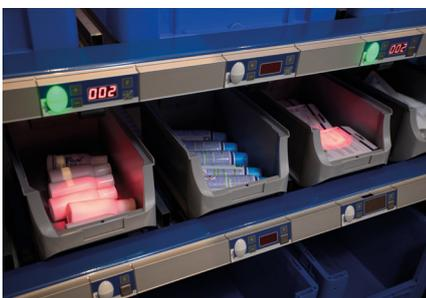
hilfe zur Verfügung. Mit der Option wird das richtige Entnahme- bzw. Ablagefach bei der Kommissionierung noch deutlicher signalisiert. Ein LED-Spot leuchtet das Regalfach aus
