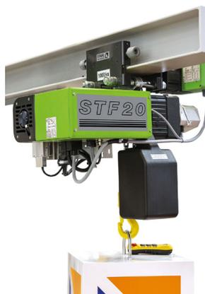
Der Elektro-Kettenzug STF der Marke Stahl Cranesystems von Columbus McKinnon ist für stufenlose Hebe- und Positionieranwendungen konzipiert. Ausgestattet sind die Hebezeuge mit den Magnetek Impulse•G+ Mini-Antrieben, die die Voraussetzungen für eine präzise Steuerung schaffen. Anschließen lässt sich der Frequenzumrichter an Feldbusysteme wie Modbus, Profibus oder Ethernet. Die Steuerungstechnik der Antriebe liefert durch den Datenaustausch mit IoT-Netzwerken auch Diagnose- und Leistungsdaten.
