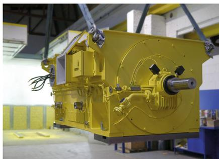
Menzel Elektromotoren hat für Tata Steel innerhalb von nur zwei Wochen einen Motor für einen Kompressorantrieb konfiguriert. Der betriebswichtige Booster-Kompressor, der wegen eines Motorausfalls stillstand, dient der Sauerstoffbereitstellung für die Stahlfertigung in einem indischen Stahlwerk. Menzel konnte dank
